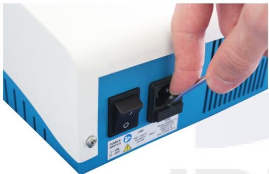
**Figura 60.** Abrindo a caixa de fusível do **THORK Shock Wave**.
