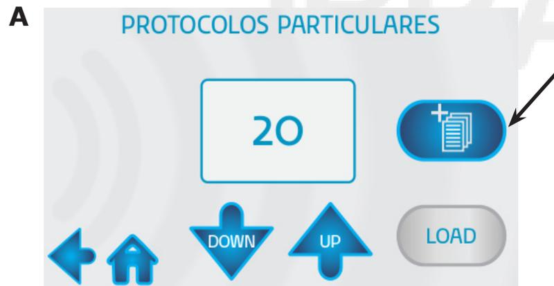
Há duas formas de se programar os parâmetros de protocolos particulares: Primeiro acionando a tecla para criar o protocolo particular **figura 74 A**, o usuário pode ajustar os parâmetros desejados para a terapia e em seguida pressionar a tecla SAVE **figura 74 B**, o equipamento salvará automaticamente os parâmetros ajustados no protocolo escolhido (Exemplo: protocolo 20). Após pressionada a tecla START surgirá a tela de execução da terapia **figura 75**.
