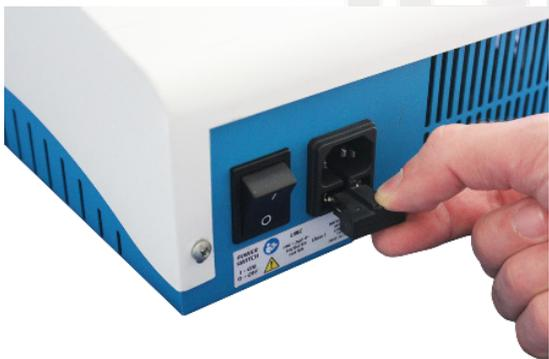
**Figura 61.** Remoção da gaveta da caixa de fusível.
