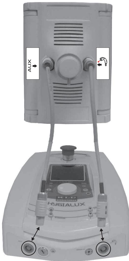
Conexão para painéis emissores:
