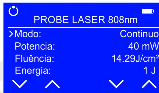
Imagem 25. Tela padrão da **Probe 4 - LASER 808 nm**.
