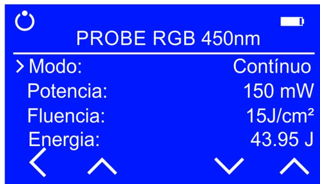
Imagem 37. Parâmetros do comprimento de onda **450 nm**.
