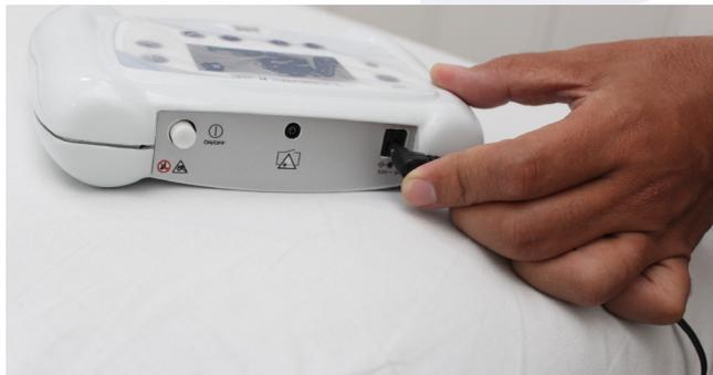
Imagem 14. **A** e **B**, conexão do cabo da fonte de alimentação elétrica no equipamento e na rede elétrica.
