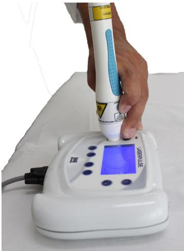
Imagem 20. Posicionamento da Probe sobre o CHECK de emissão.
