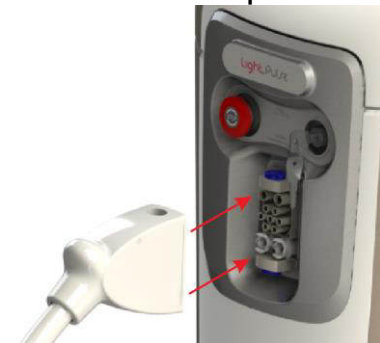
Sentido de encaixe do aplicador
