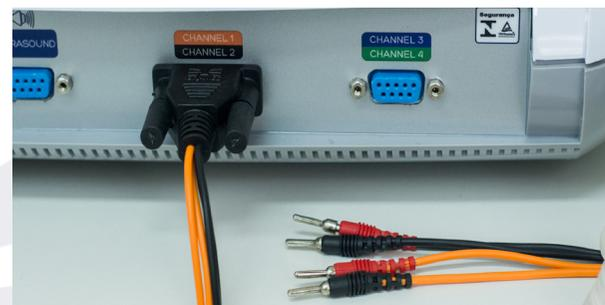
**Nota:** Utilizar cabos com extremidades pino banana (4 mm) nos canais 1 e 2.
