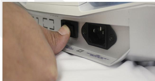
Imagem 76. A, abrindo a caixa de fusível; B, removendo a gaveta da caixa de fusível e C, reposicionando a gaveta da caixa de fusível.
