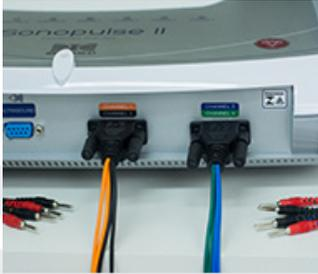
Conecte no equipamento os cabos de estimulação para corrente Aussie.
