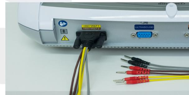
**Nota:** Utilizar cabos conectores com extremidades pino banana (2 mm) no canal High Volt.
