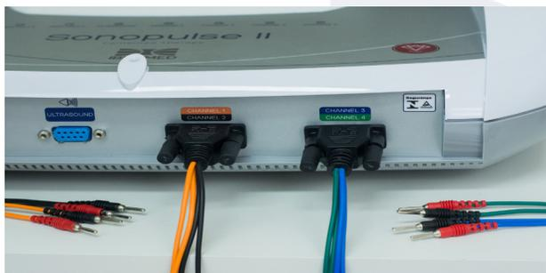
**Nota:** Utilizar cabos com extremidades pino banana (4 mm) nos canais 1, 2, 3 e 4.
