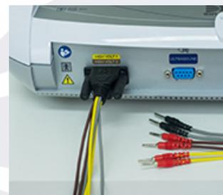
Conecte no equipamento o cabo de estimulação para corrente High Volt.
