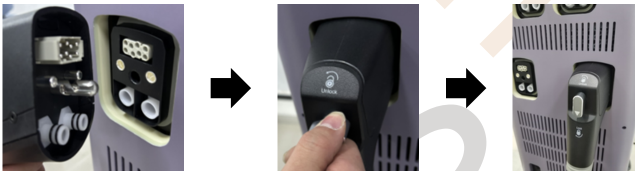
FIGURA 6. DIAGRAMA ESQUEMÁTICO DE ACOPLAMENTO DOS APLICADORES
