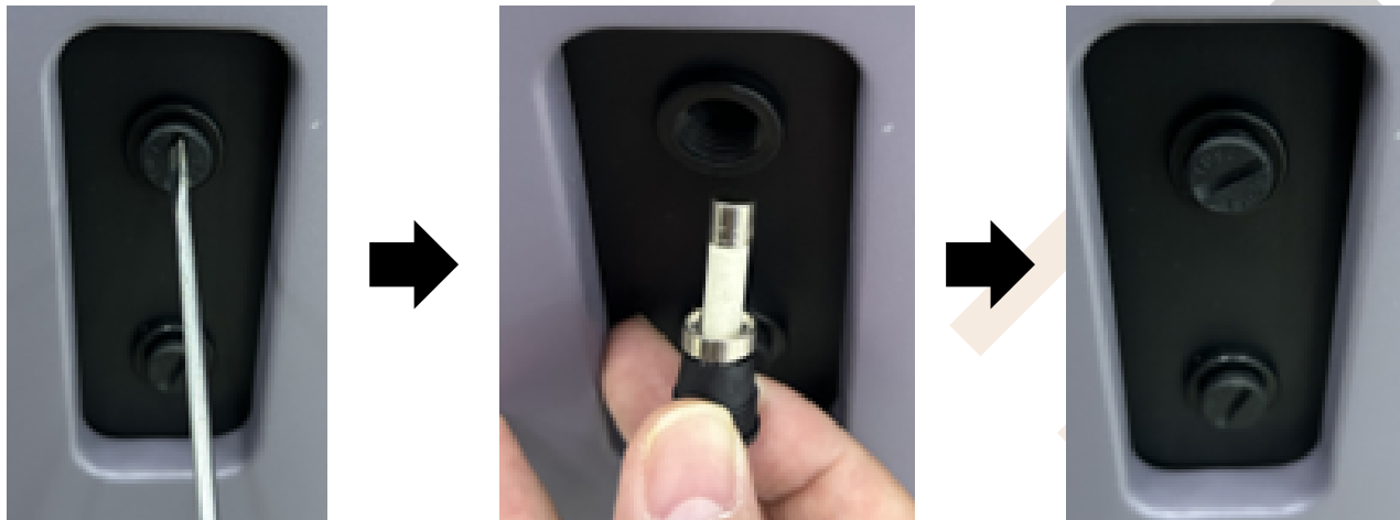
FIGURA 10. DIAGRAMA ESQUEMÁTICO DE SUBSTITUIÇÃO DO FUSÍVEL
